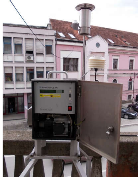
Мерно место 1 – „К.Новаковић“ - Апарат за узорковање суспендованих честица
