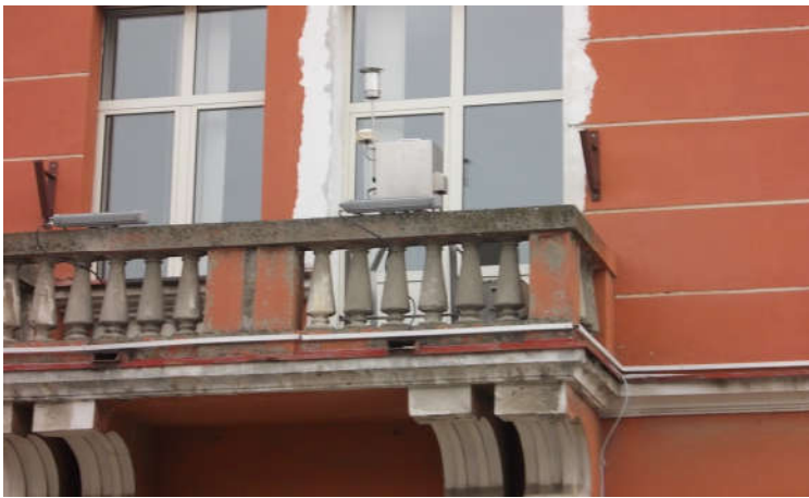
Мерно место 1 – „К.Новаковић“ - Апарат за узорковање суспендованих честица
